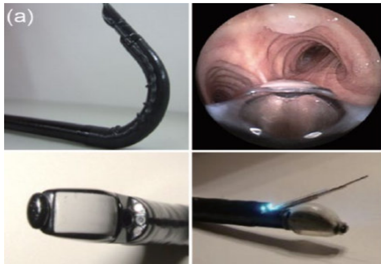
Hình 1. Đầu nội soi siêu âm đầu dò thấu kính lồi và kim sinh thiết.
